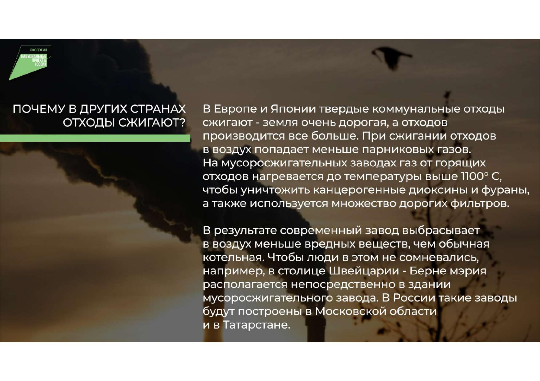
В Европе и Японии твердые коммунальные отходы сжигают - земля очень дорогая, а отходов производится все больше. При сжигании отходов в воздух попадает меньше парниковых газов. На мусоросжигательных заводах газ от горящих отходов нагревается до температуры выше 1100° С, чтобы уничтожить канцерогенные диоксины и фураны, а также используется множество дорогих фильтров.
